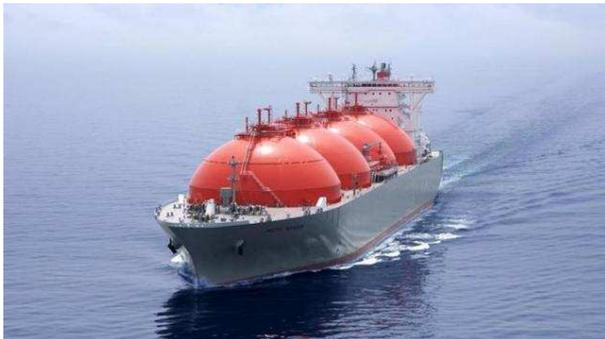
Lorsque le transport par gazoduc coûte trop cher ou est impossible, le gaz est acheminé sous forme liquide par bateaux (les méthaniers). A environ  $-161^{\circ}\text{C}$ , le gaz peut en effet être transporté sous forme liquide : on parle alors de gaz naturel liquéfié (GNL). Cette méthode constitue une alternative aux gazoducs qui sont des infrastructures de transport figées.
